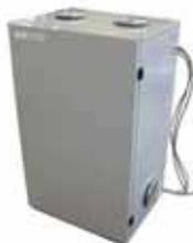
Geregelte Wohnungslüftung mit 95 % Wärmerückgewinnung durch Aluminium-Kanal-Gegenstromwärmeübertrager, Gleichstrommotoren und automatischem Bypass
